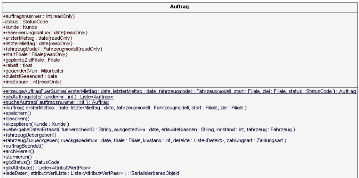
Abb. 20 detailliertes Klassendiagramm: Auftrag
